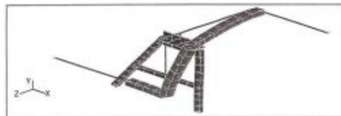
Bild 16. FE-Modell mit A-Stütze und Elastomer, 1. Biegeeigenfrequenz 79,4 Hz.
