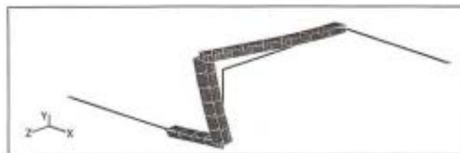
Bild 15. FE-Modell der ursprünglichen Rohrleitung, 1. Biegeeigenfrequenz 60,7 Hz.
