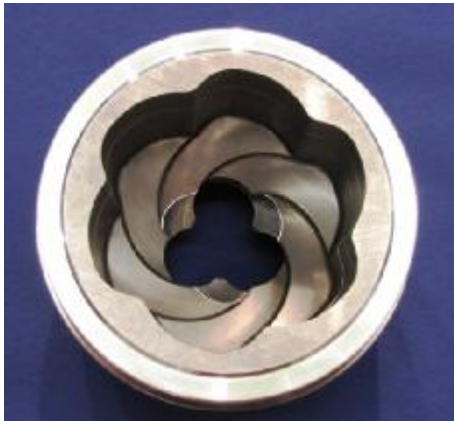
Abbildung 6: a) optimierte Strangpressmatrize, b) Erhöhung der Konturgenauigkeit durch Optimierung des Werkstoffflusses.
