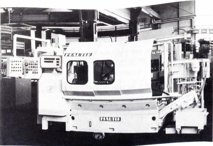
Bild 1b. Rotorfräsmaschine PFAUTER.
