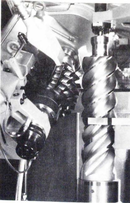
Bild 6. Wälzfräsen von Rotoren.
