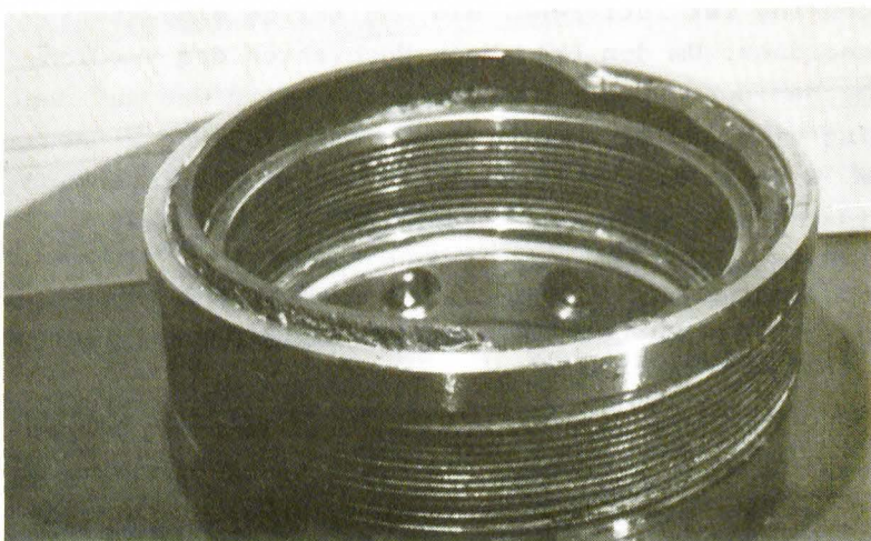
Bild 7 Gleitring mit Kantenabplatzungen am Außendurchmesser
