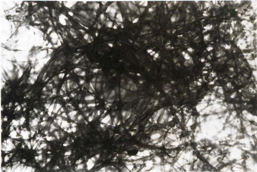
Bild 8: Filterelement aus dem Betrieb mit einem dispergierenden Öl (Spezialverdichteröl),  $\Delta p$  0,2 bar
