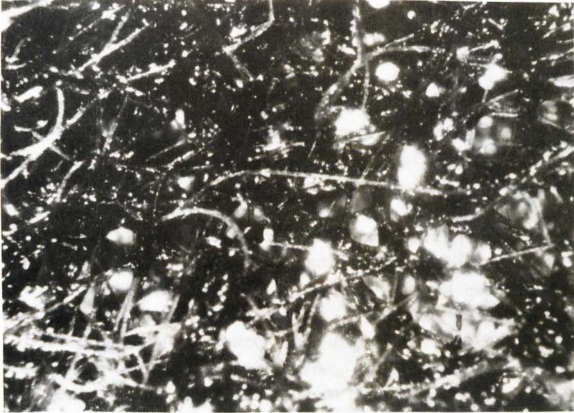
Bild 7: Filterelement aus dem Betrieb mit einem nicht dispergierenden Öl (Hydrauliköl),  $\Delta p$  1,4 bar
