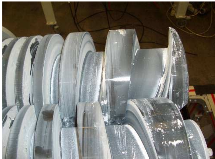
Abb. 6: Rotoren einer SP630 nach Förderung großer Mengen feinen Staubes vor der Reinigung
