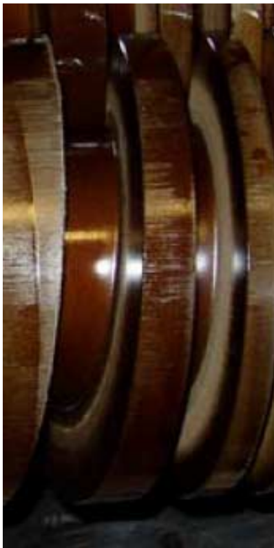
Abb. 8: Rotor einer ScrewLine SP630 nach Förderung von Sinterwachs vor (links) und nach der Reinigung mit Wasser im Betrieb (rechts)
