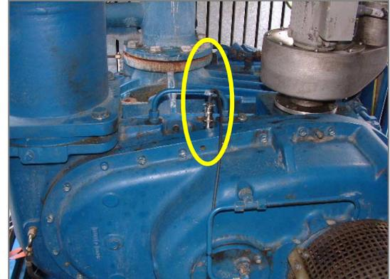
Bild 9a: Aufnehmer B-Seite radial horizontal und axial    Bild 9b: Aufnehmer B-Seite vertikal
