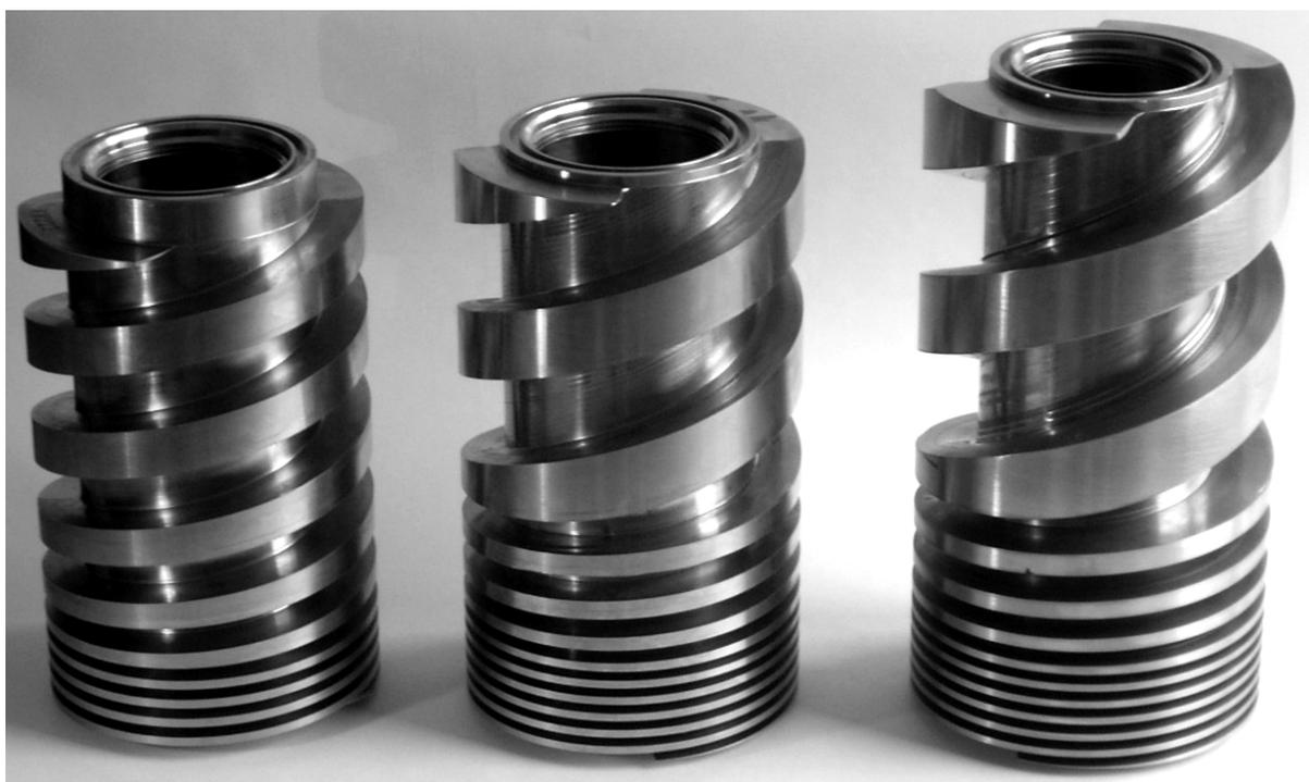
Bild 3: Verdränger mit verschiedenen inneren Verdichtungen.
