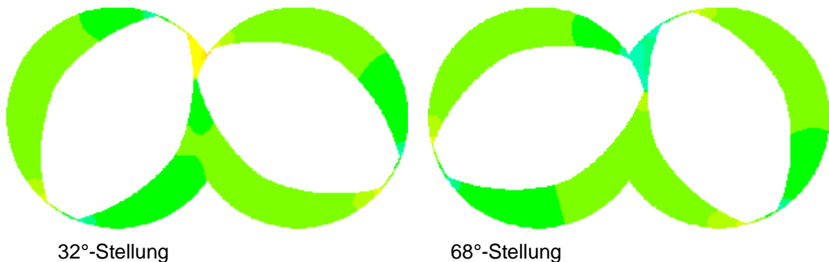
Bild 5: Druck bei einer Druckdifferenz von 0 Pa. Die Farbskalierung reicht von -35 bar (blaue Farbe) bis +35 bar (rote Farbe).
