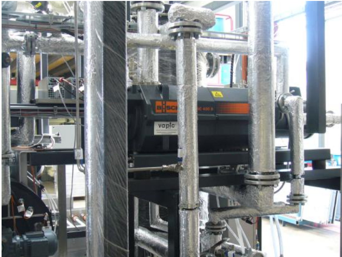
Bild 8: Reinigungsanlage der Fa. Vaptic mit einer COBRA NC 0400 B
