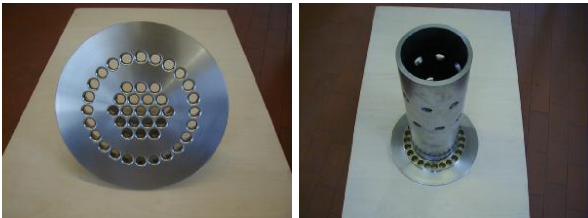
Bild 9: Lösungsvorschlag Pulsations-Dämpferplatten mit Quermodenbrecher.
