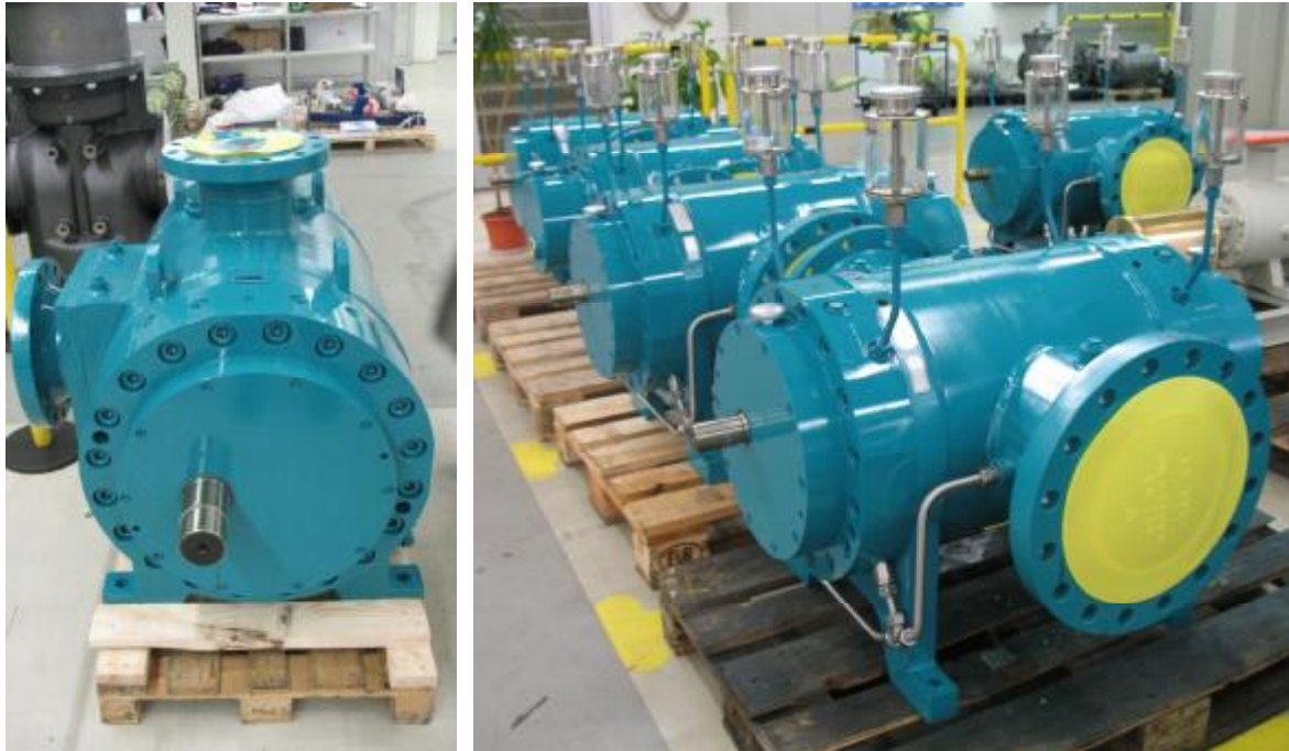
Abbildung 9 und 10: Ausgeführte Hoch- und Mitteldruckpumpen
