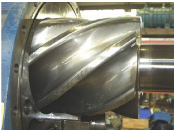
Bild 3 Nebenrotor mit abgearbeiteten Dichtleisten nach Demontage
