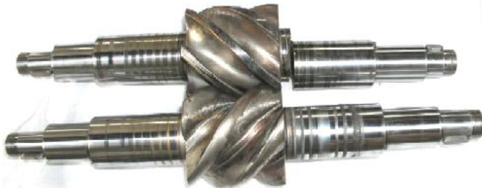
Bild 19 Hauptrotor (unten) und Nebenrotor (oben) der 3. Stufe: Zapfenbruch am Nebenrotor der Druckseite
