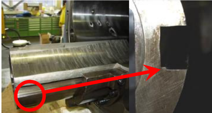
Bild 2 Steuerschieber mit eingearbeiteten Führungsnuten
