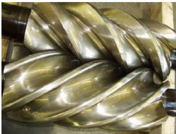
Bild 1 Abgearbeitete Dichtleisten von Haupt- und Nebenrotor
