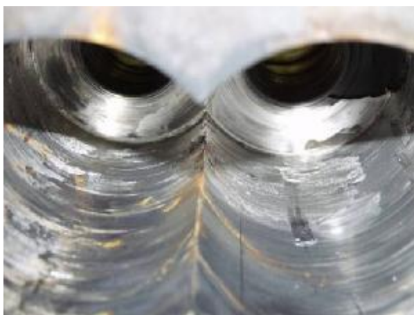
Bild 13 Zylinder mit Materialauftrag stirnseitig und Abtrag am Umfang
