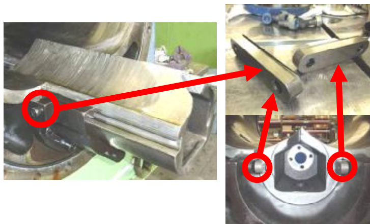
Bild 6 Anlaufspuren am Steuerschieber und Abtrag unterhalb der Passfedern
