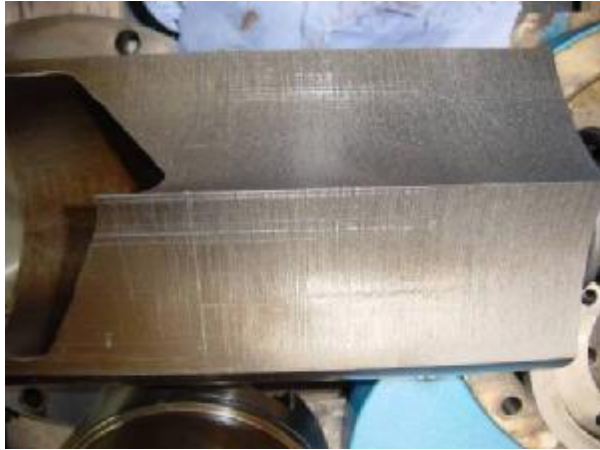
Bild 17 Anlaufspuren auf dem Leistungsschieber
