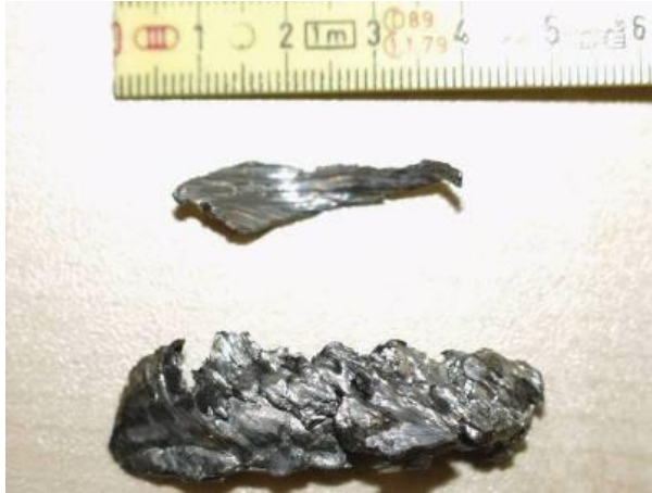
Bild 9 Späne der Rotoren aus Druckleitung hinter Verdichter
